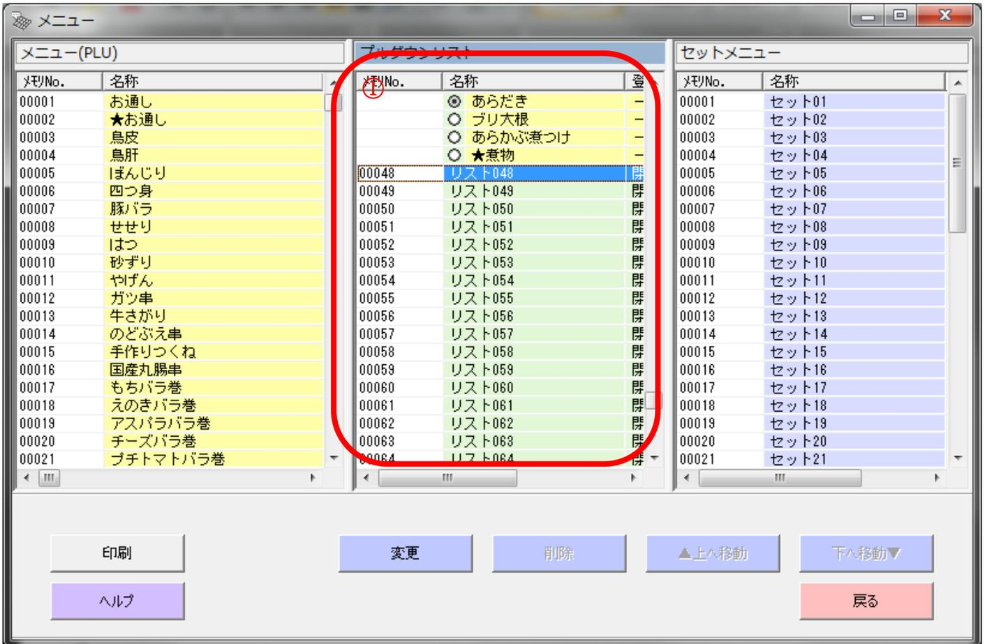
① 使用するプルダウンリストを選び、ダブルクリックまたは変更をクリックします。
